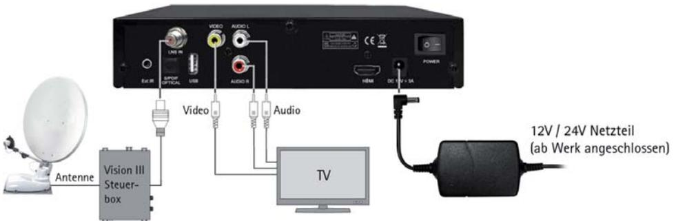
Schließen Sie das Koaxkabel (Antennenkabel von Ihrer VisionIII Steuerbox) am Anschluss „LNB IN“ auf der Rückseite des Receivers an.
